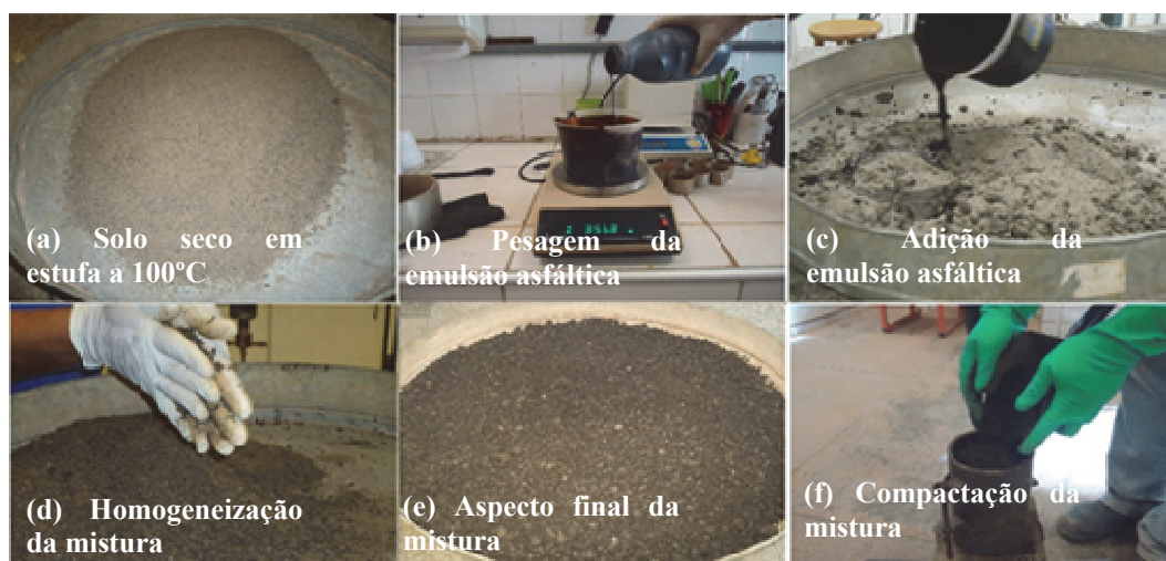
Fig. 10 – Procedimentos de confecção das misturas solo-emulsão.
