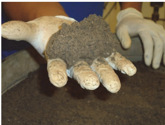
Fig. 11 – Aspecto da mistura solo-emulsão após amassamento manual no teor de emulsão inicial.
