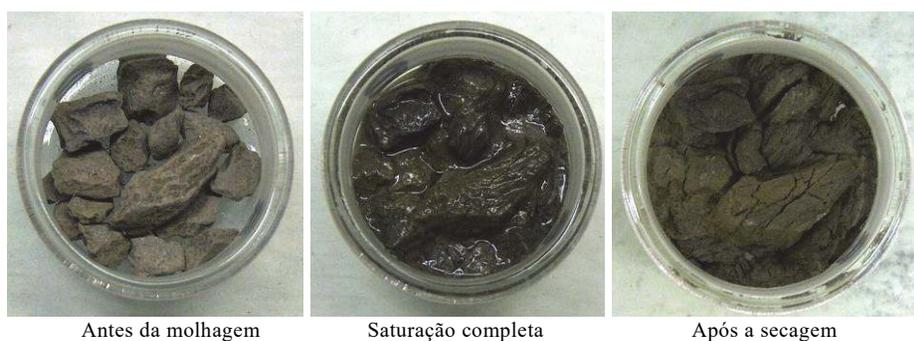
**Fig. 1** – Degradação de fragmentos de margas quando saturados ( $4,75 \text{ mm} < D \leq 9 \text{ mm}$ ).
