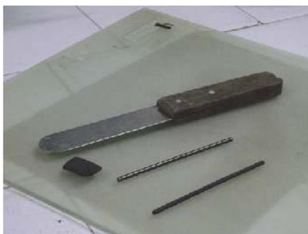
**Fig. 15** – Ensaio para determinação do limite de plasticidade.
