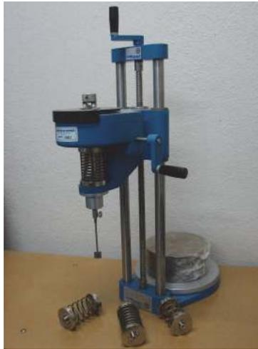
**Fig. 9** – Equipamento para ensaio de palheta miniatura (“mini-vane”).
