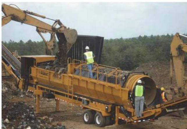
**Fig. 15** – Fase de separação e classificação dos materiais transacionáveis e resíduos (IWCS, 2009).
