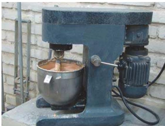
**Fig. 4** – Misturador elétrico (argamassadeira).
