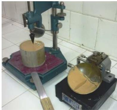
**Fig. 14** – Métodos para a determinação do limite de liquidez – cone de queda (à esquerda) e aparelho de Casagrande (à direita).
