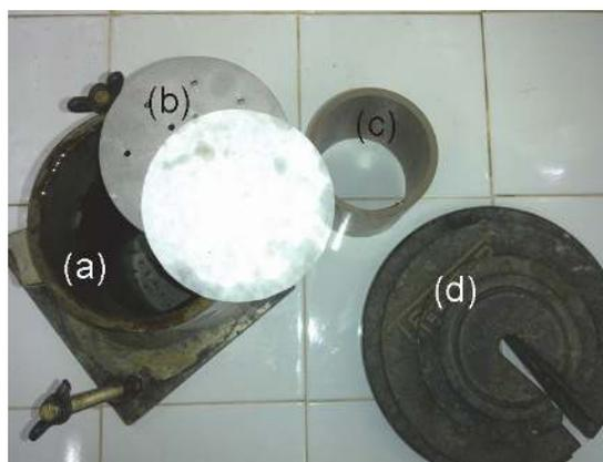
**Fig. 5** – Conjunto utilizado para o adensamento das amostras.
