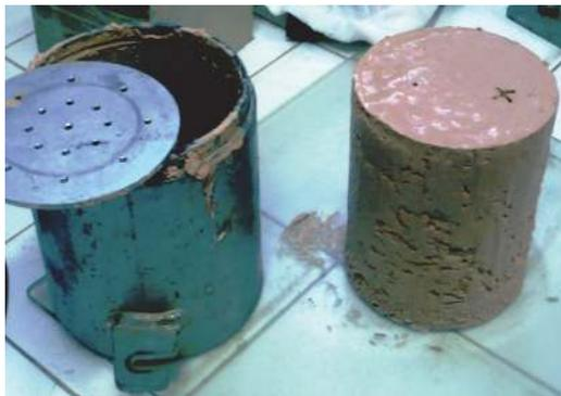
**Fig. 11** – Corpo de prova retirado do molde.
