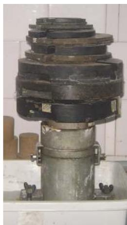
**Fig. 6** – Amostra em adensamento.
