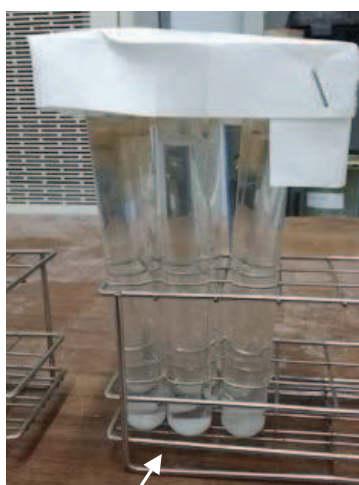
Fig. 2 – Ensaios em tubos de ensaio. Precipitação de \text{CaCO}_3 .
