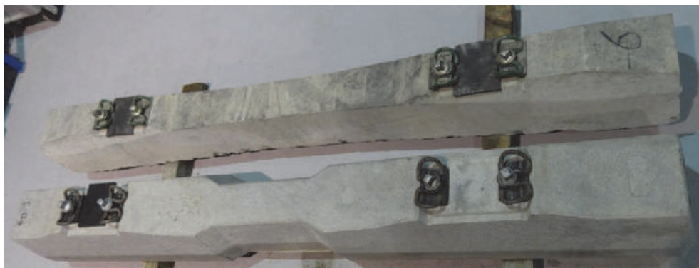
Fig. 18 – Fotografía de las dos traviesas utilizadas en los ensayos (arriba, la traviesa española y abajo la alemana).
