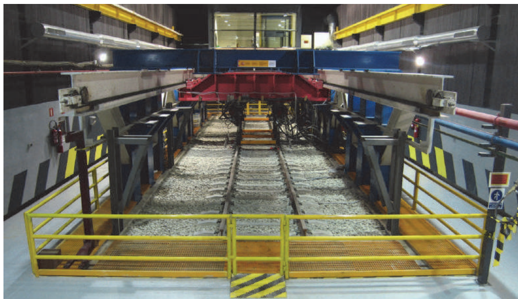
Fig. 1 – Vista general del Cajón Ferroviario.
