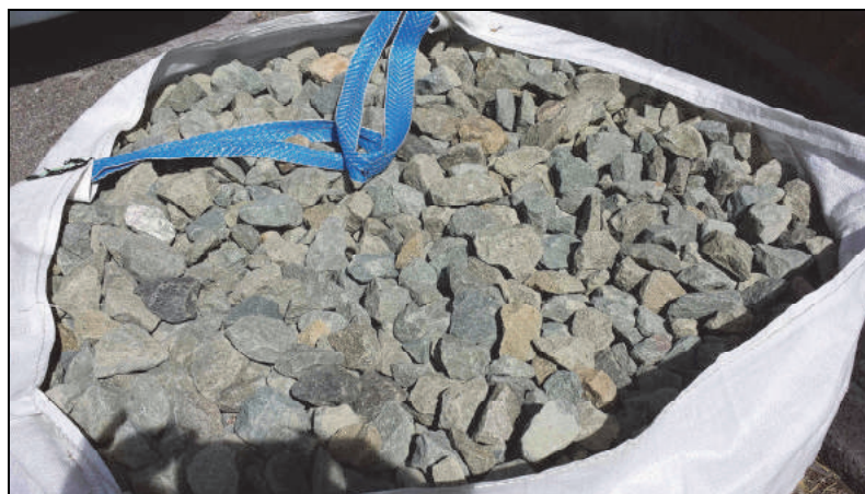
Fig. 6 – Aspecto del balasto utilizado en los ensayos.
