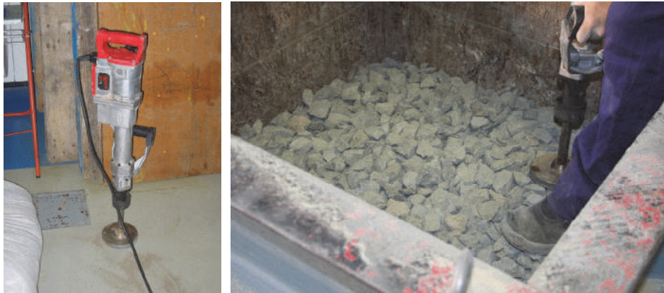
Fig. 9 – Compactadora manual utilizada en los ensayos.
