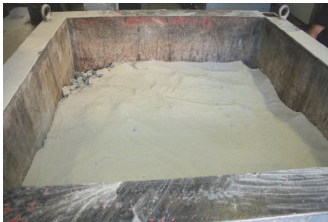
Fig. 10 – Aspecto de una capa de balasto completamente contaminada con arena fina y uniforme.
