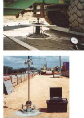
**Fig. 23** - Módulo da fundação  $E_f$  e ensaios de carga para o obter.
