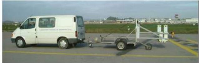
Medição das Espessuras das camadas com radar
