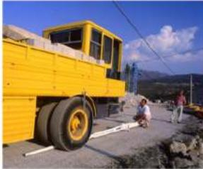
Ensaio de Carga com Pneu e defletógrafo LNEC
