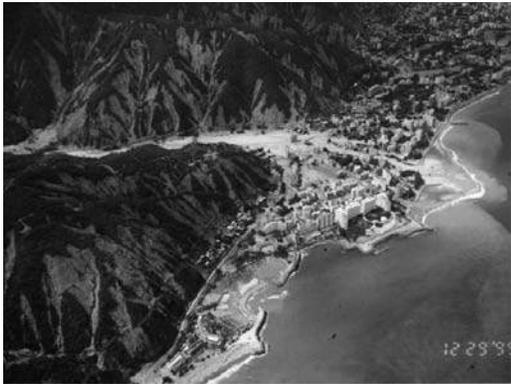
Cone de dejecção dos depósitos de torrente na parte terminal da Quebrada Seca, em Cerro Grande (Jakob e Hungr, 2005).
