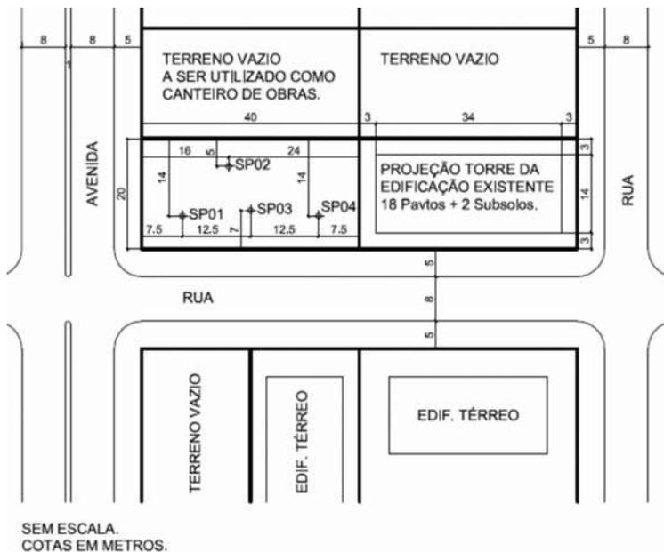
Fig. 7 – Localização esquemática das sondagens e condições do entorno da obra.
