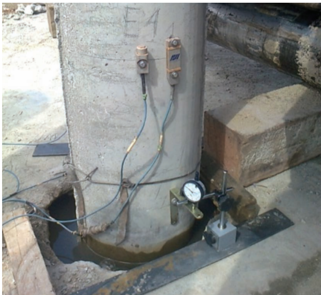
Fig. 2 – Leitura de recalques com relógio comparador (ampliação da Figura 1, em destaque).
