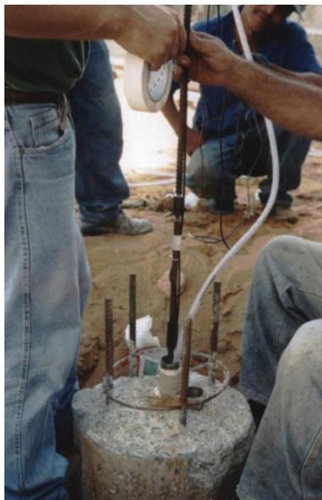
**Fig. 2b** – Instalação da instrumentação.
