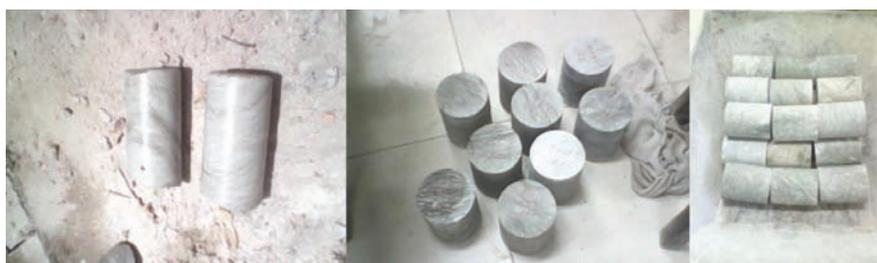
**Fig. 8** – Corpos de prova com dimensões de acordo com a NBR NM 7680/07 (2007).
