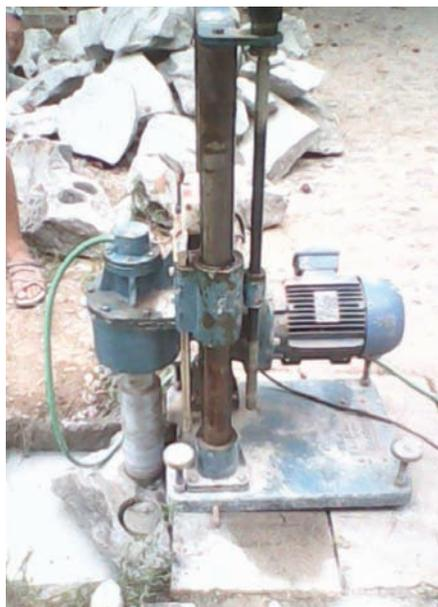
**Fig. 6** – Máquina de extração de testemunhos.
