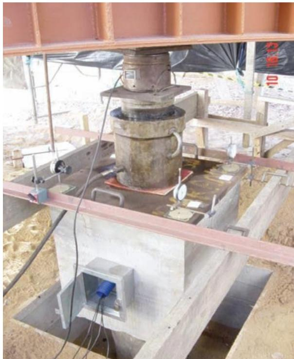
**Fig. 3** – Detalhe da montagem da prova de carga.
