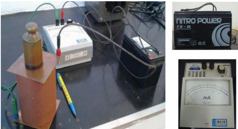
Fig. 7 – Esquema para a leitura da corrente elétrica do solo compactado.
