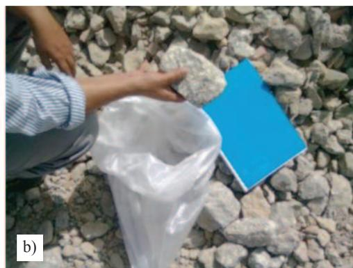
**Fig. 2** – Amostragem do AB<sub>RCD</sub>: a) pilha de material; b) recolha de um bloco.
