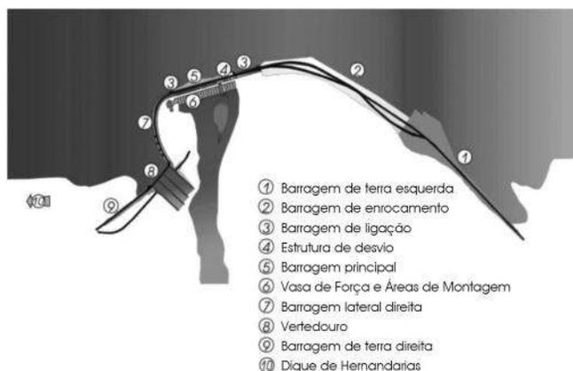
Fig. 5 – Complexo de barragens de Itaipu Binacional, adaptado de Itaipu (2013).
