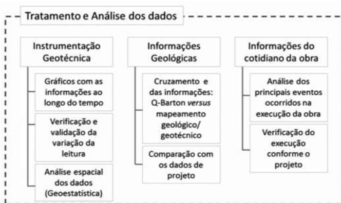
Fig. 2 – Tratamento e análises dos dados monitorados durante a execução da obra.
