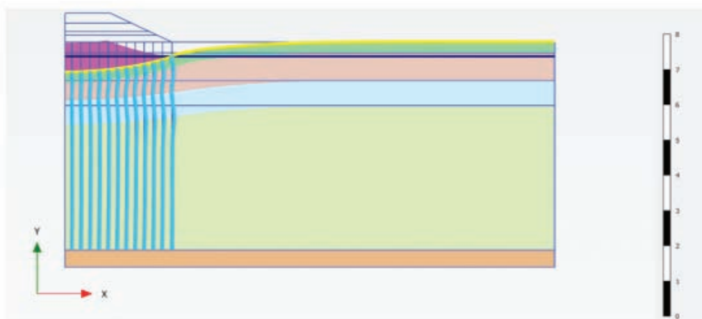
Fig. 5 – Deformada do modelo no final do período de tempo analisado.
