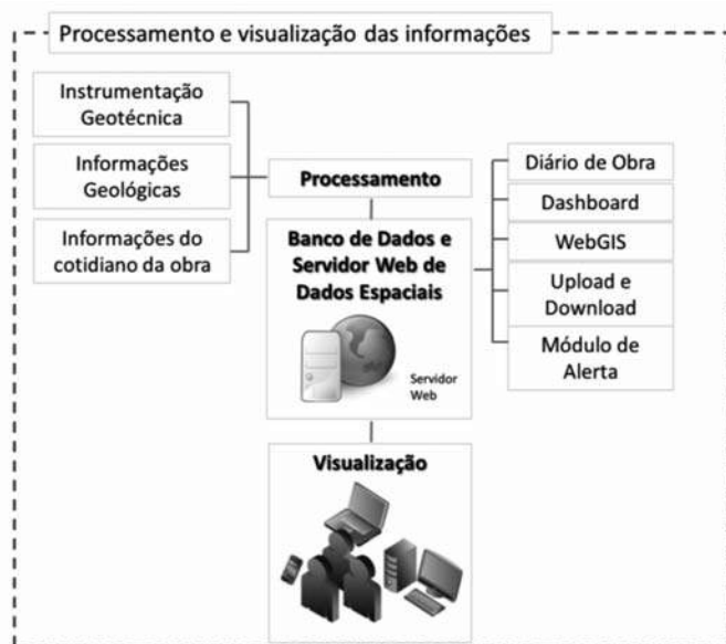
Fig. 3 – Processamento e visualização dos dados monitorados na obra.
