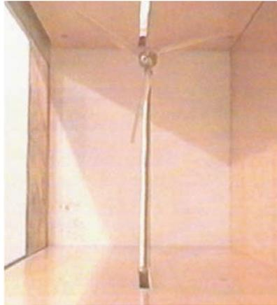
**Fig. 20** – Modelo reduzido do aerogerador montado no interior do túnel de vento.
