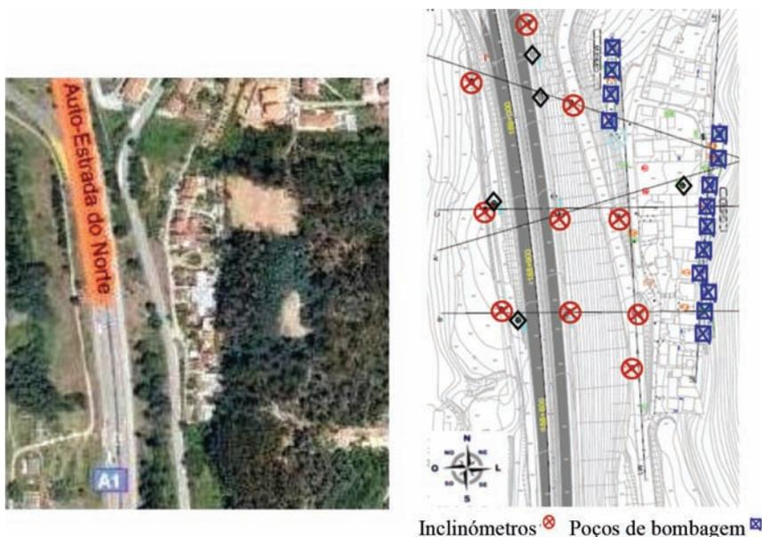
Fig. 12 – Talude em Coimbra instrumentado pelo LNEC.
