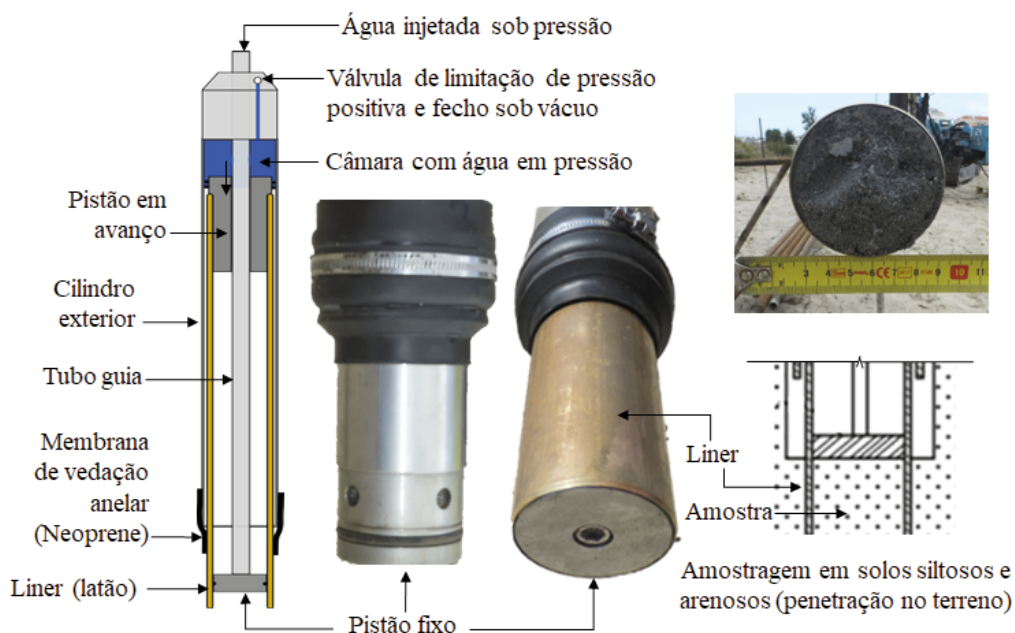
Fig. 1 – Diagrama dos componentes do amostrador D&M
