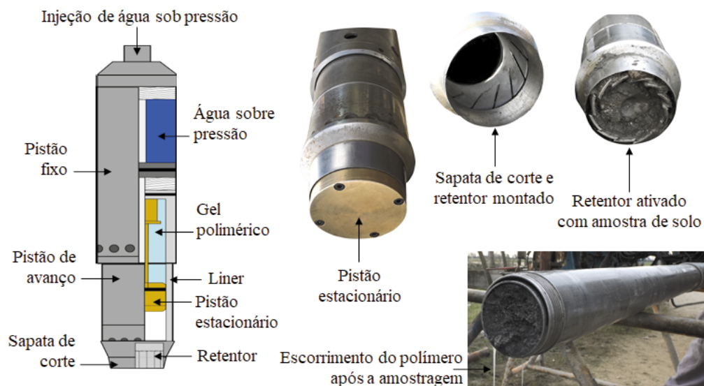
Fig. 2 – Diagrama dos componentes do GP-S
