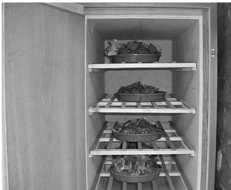
**Fig. 7** – Amostras na estufa para determinação do teor de umidade dos RSU.
