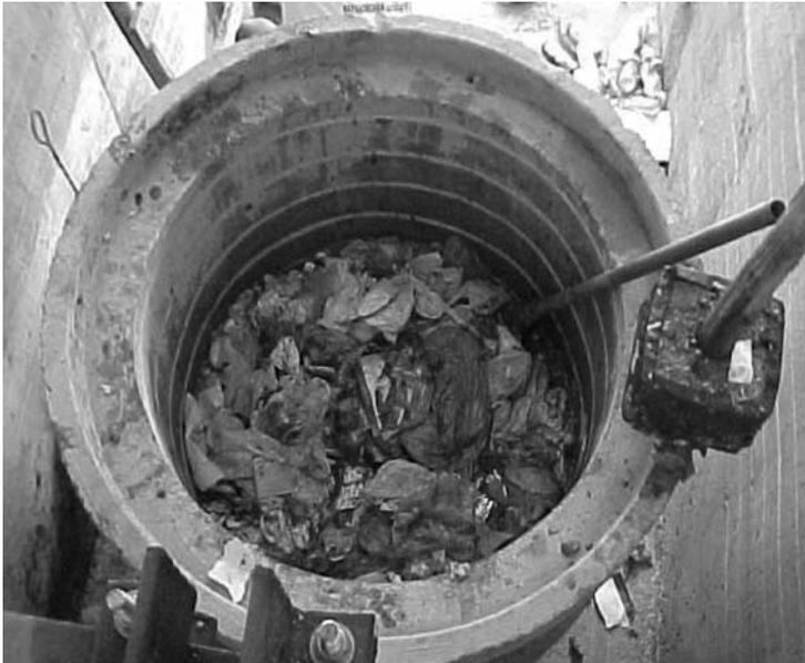
Fig. 12 – Representação da disposição do RSU em camadas.
