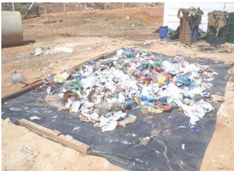
**Fig. 1** – Espalhamento da amostra de RSU.
