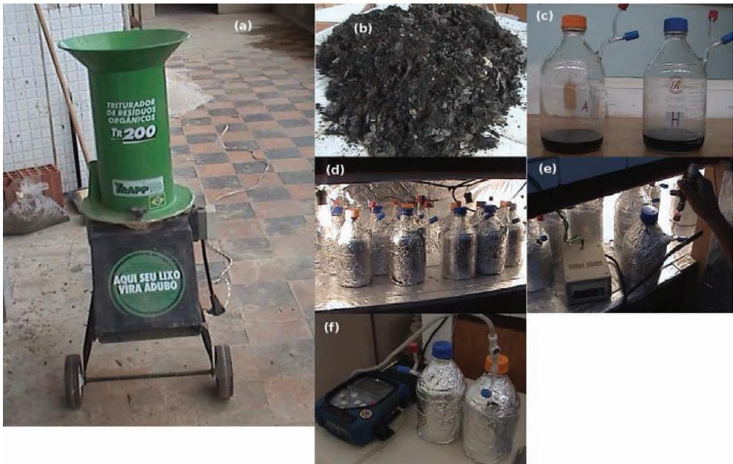
**Fig. 3** – Realização dos ensaios de BMP. a) Trituração e homogeneização; b) Amostra de RSU; c) Disposição das amostras nos reatores; d) Acondicionamento dos reatores (38 – 40°C); e) Medida da pressão de gás nos reatores; f) Medida da composição do biogás.
