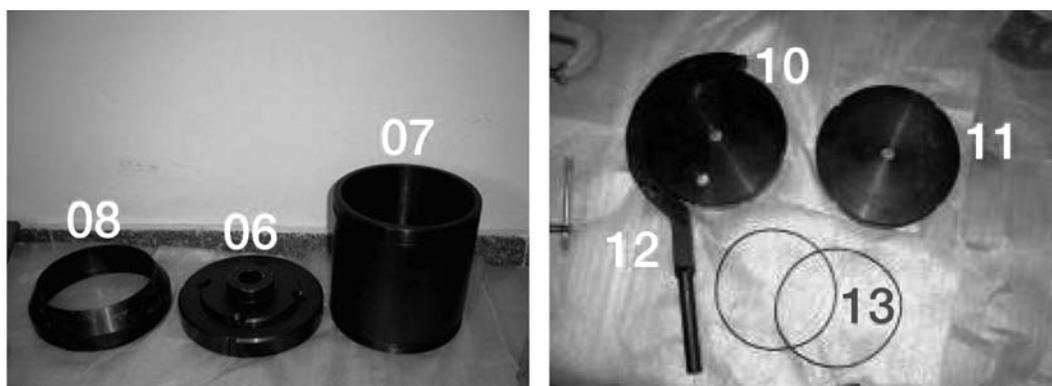
a) Amostrador e anéis de cravação e extração
