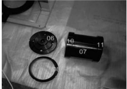
b) Conjunto de ensaio e anéis de cravação
