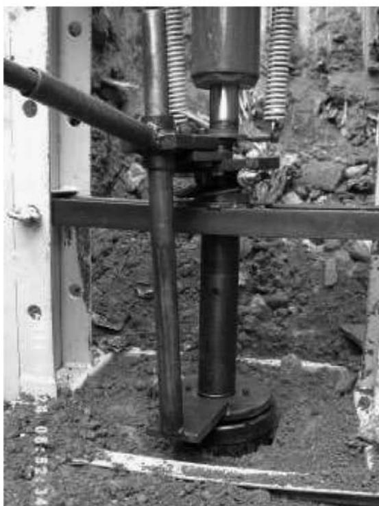
**Fig. 6** – Foto superior: em destaque o dispositivo de giro e o apoio de reação superior (pneu)
