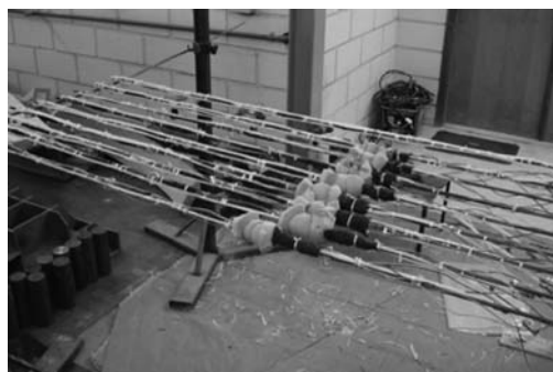
Fig. 4 – Detalhe das barras de aço preparadas para serem inseridas no maciço de solo.
