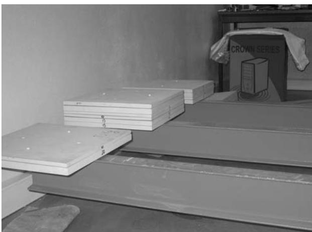
**Fig. 11** – Braço multiplicador onde são aplicados os pesos que materializam a carga transmitida ao provete durante o ensaio.
