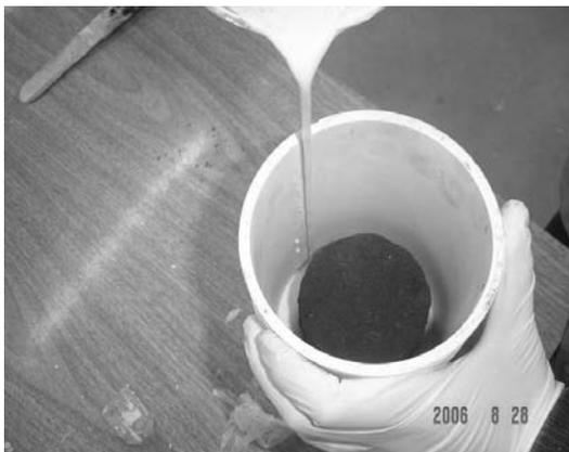
Fig. 4 – Corpo de prova sendo revestido com gesso.
