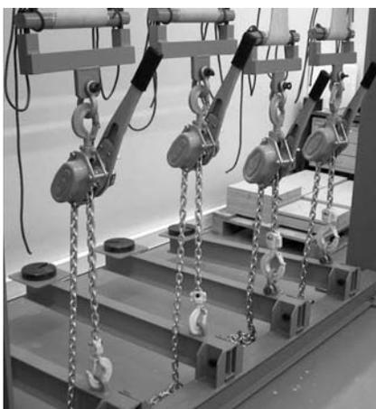
**Fig. 12** – Alavanca usada para transmitir a carga aplicada no braço multiplicador ao provete e que permite o ajuste da posição do braço
