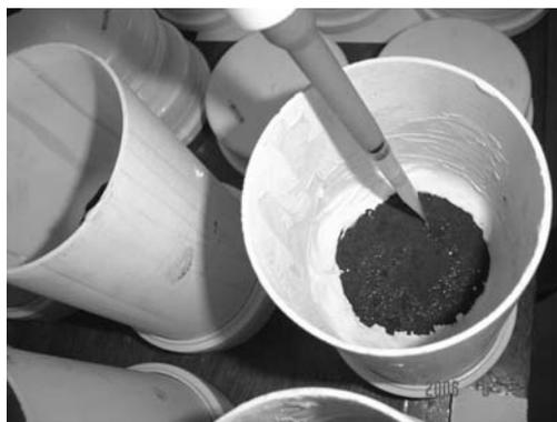
**Fig. 6** – Aplicação das bactérias bioaugmentadas no solo.
