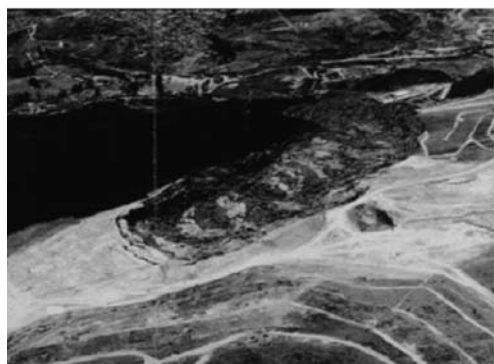
b) Aterro de Rumpke, Estados Unidos: rotura na interface areia/geomembrana
