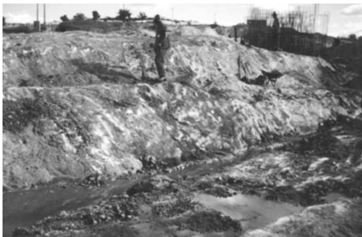
Fig. 5 – Detalhe do ressalto topográfico existente entre as litologias dos gnaisses bandados (Setor II-A-B1) e os anfibolitos (Setor II-B-B1).
