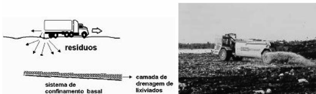
Fig. 6 – Recirculação de lixiviados: método de irrigação por pulverização (Reinhart, 2005 e Koerner, 2006).
