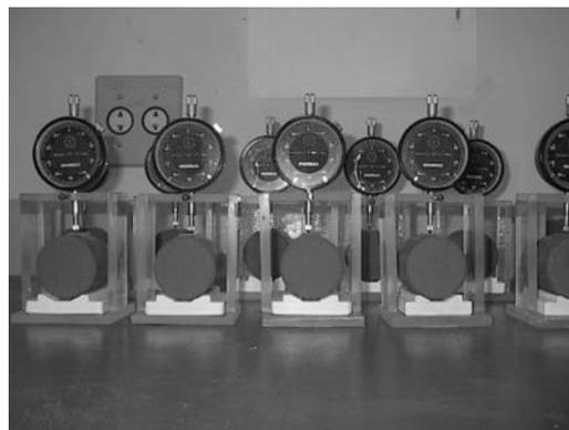
**Fig. 3** – Medição da contração diametral dos corpos de prova.
