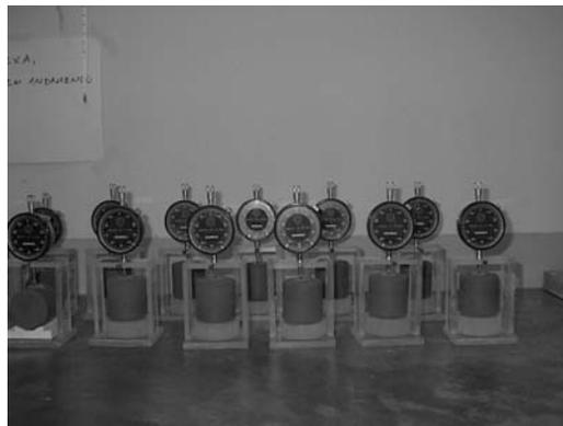
**Fig. 2** – Medição da contração axial dos corpos de prova.
