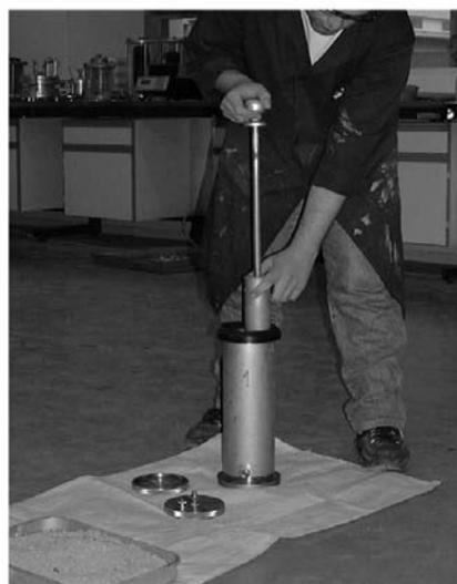
**Fig. 11** – Conjunto de compactação e manobra de compactação.
