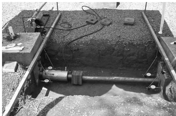
Fig. 4 – Esquema de montagem das provas de carga.
