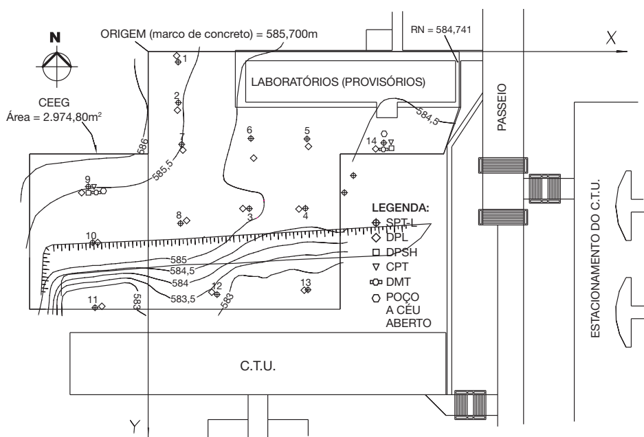
Fig. 1 – Planta do CEEG com furos de sondagens distribuídos na área.
