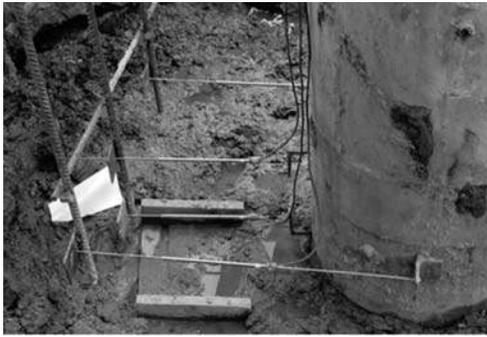
**Fig. 28** – Disposição dos transdutores na estaca E800H-1 (Santos e Gouveia Pereira, 2005).
