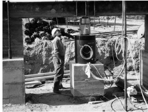
**Fig. 15** – Ensaios de estacas no Pavilhão de Portugal - EXPO'98: Sistema de reacção com estacas em tracção (LNEC, 1996, citado por Sousa Coutinho, 2006).
