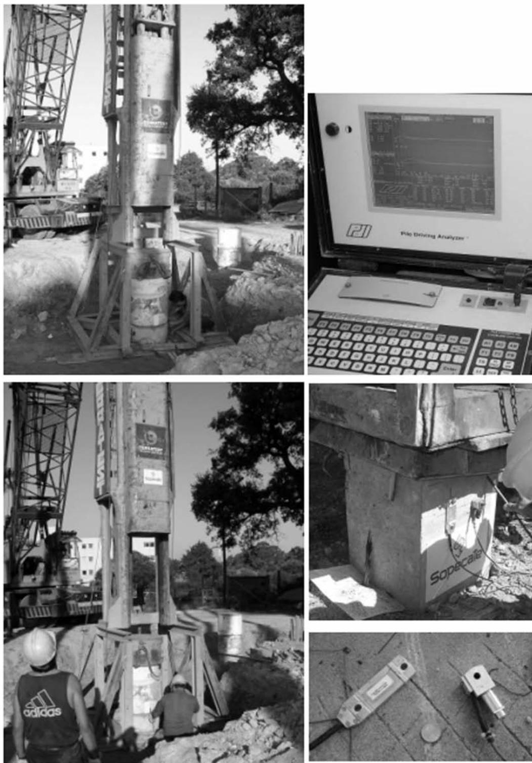
Fig. 33 – Ensaio estático e dinâmico em estacas no Campo Experimental da FEUP (ISC'2).
