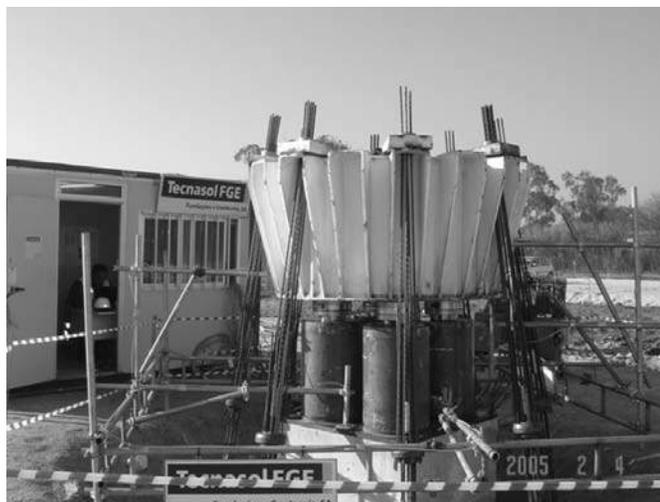
**Fig. 20** – Ensaio de carga vertical - IP6 Viadutos na ligação Peniche-A8 (Tecnasol FGE).
