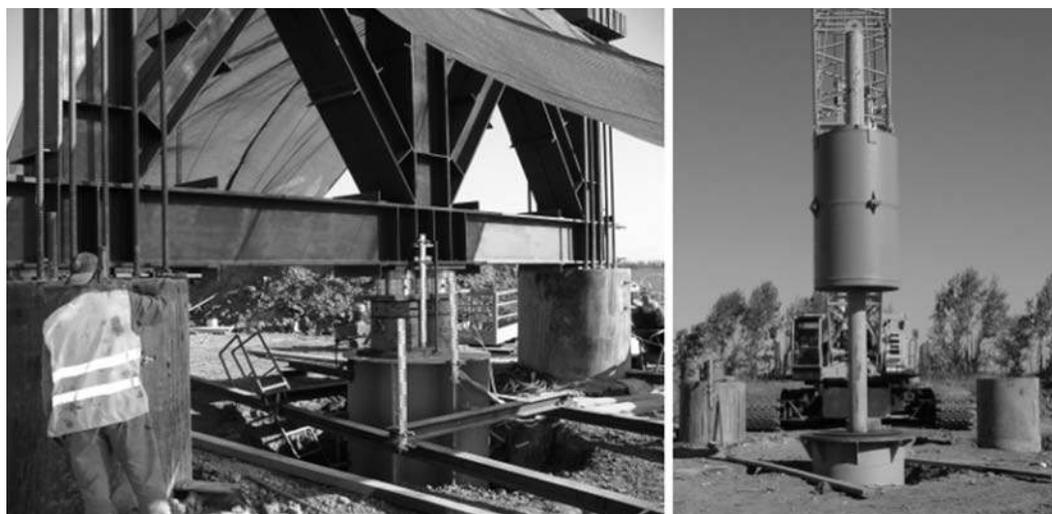
Fig. 32 – Ensaios estáticos e dinâmicos em estacas na Nova Travessia do Tejo no Carregado.
