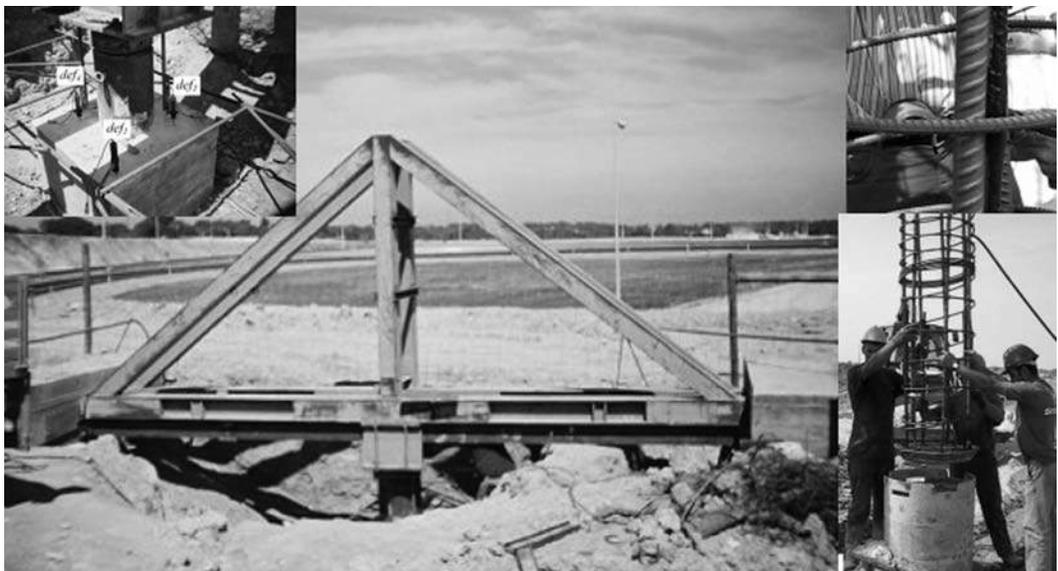
**Fig. 25** – Vista geral e pormenores da instrumentação do ensaio estático com a estrutura de reacção – Santo Estevão (Gouveia Pereira, 2003).
