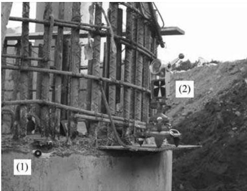
**Fig. 9** – Reflectores para leituras: (1) do teodolito; (2) do distanciómetro (Sousa Coutinho, 1995).
