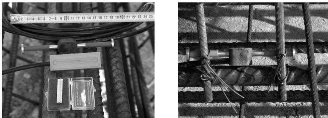
**Fig. 22** – Extensómetros eléctrico e de corda vibrante soldados a um varão da armadura (IP6, Viadutos sobre os rios Galvão e Real. A2P/IEP/Tecnasol, 2005).
