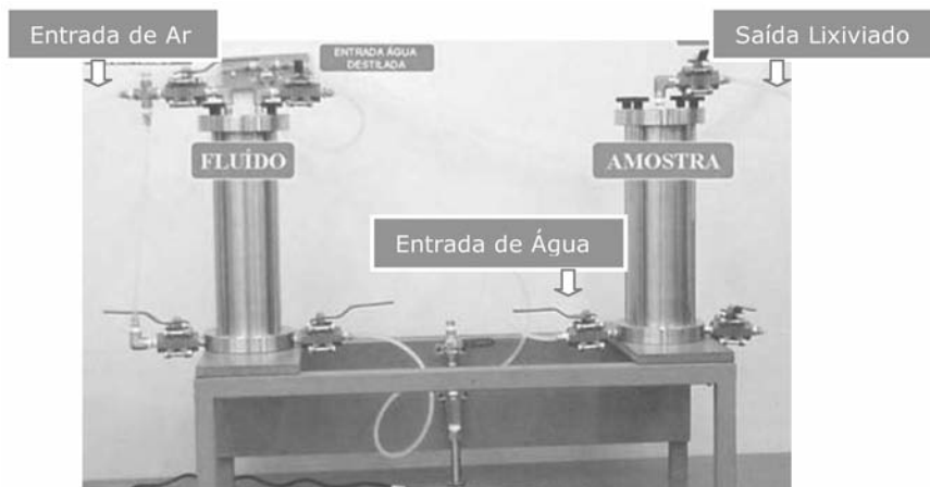
Fig. 4 – Equipamento de lixiviação em coluna desenvolvido no programa experimental.
