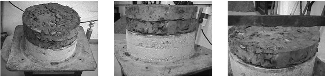
**Fig. 19** – Provete com 60% de grossos e um teor em água de 8,8%.
