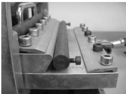
**Fig. 4** – Esticador utilizado para eliminação de folgas entre o geossintético e a placa.
