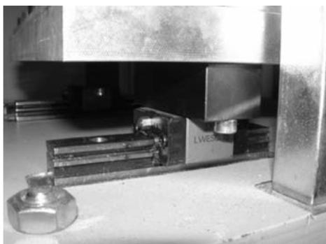
**Fig. 2** – Régua de deslizamento sem atrito da placa inferior.
