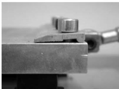
**Fig. 3** – Garras de fixação da película abrasiva/provete de geossintético à placa.
