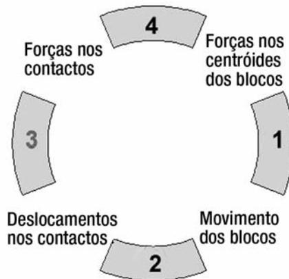
Fig. 2 – Ciclo de cálculo do Método dos Elementos Discretos.
