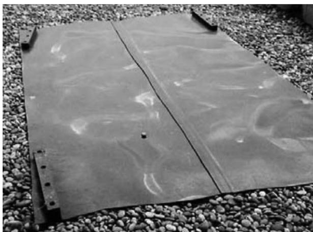
**Fig. 2** – Amostra da geomembrana, com uma dupla soldadura por termofusão, a meio.
