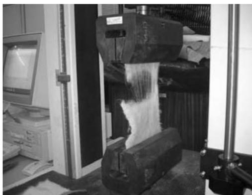
b) rotura do provete após abrasão
