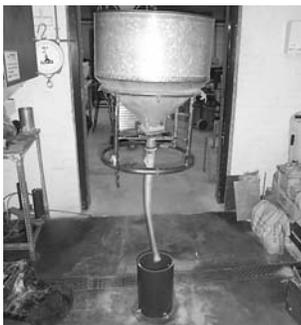
a) calibração do sistema de pluviação de areia seca
