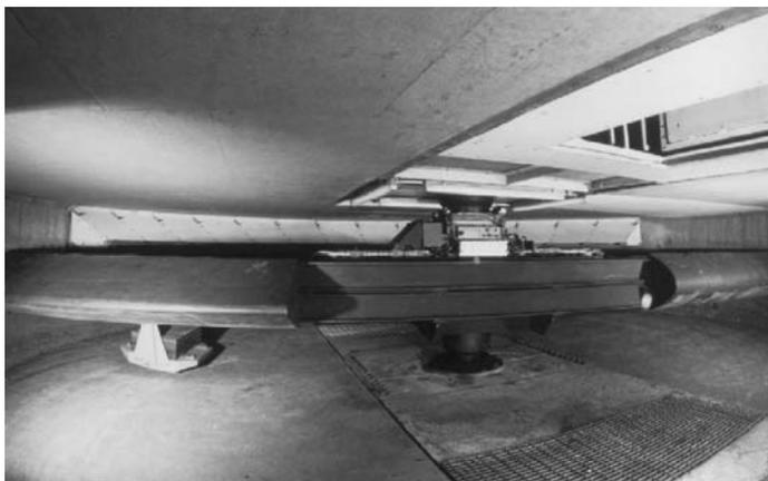
**Fig. 5** – Vista da “beam centrifuge” usada no Schofield Centre para ensaios dinâmicos
