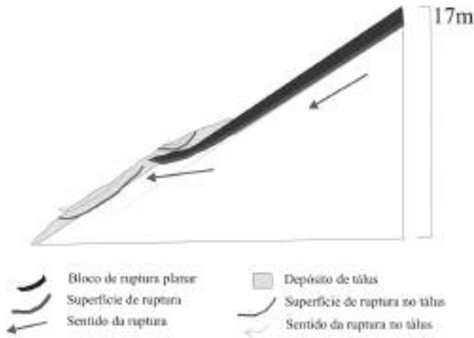
Fig. 7 – Simulação do bloco de ruptura planar do maciço rochoso, e rupturas do tálus.
