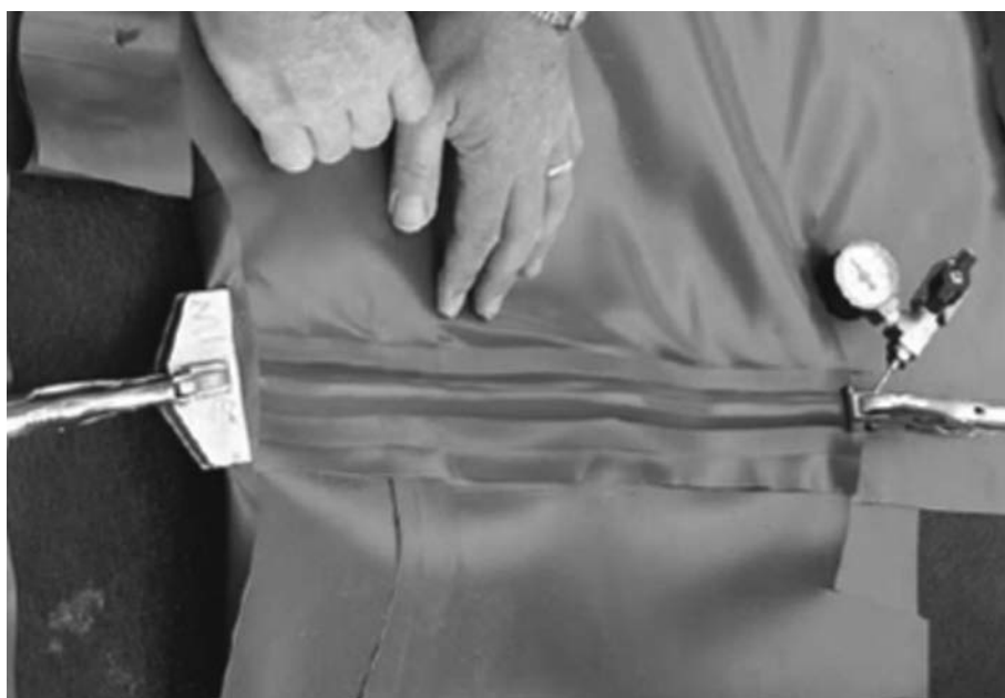
Fig. 8 – Ensaio de pressão de ar (Timothy et al., 2005).
