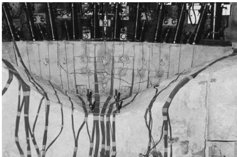
Fig. 34 – Barragem de Alqueva. Modelo após o ensaio.
