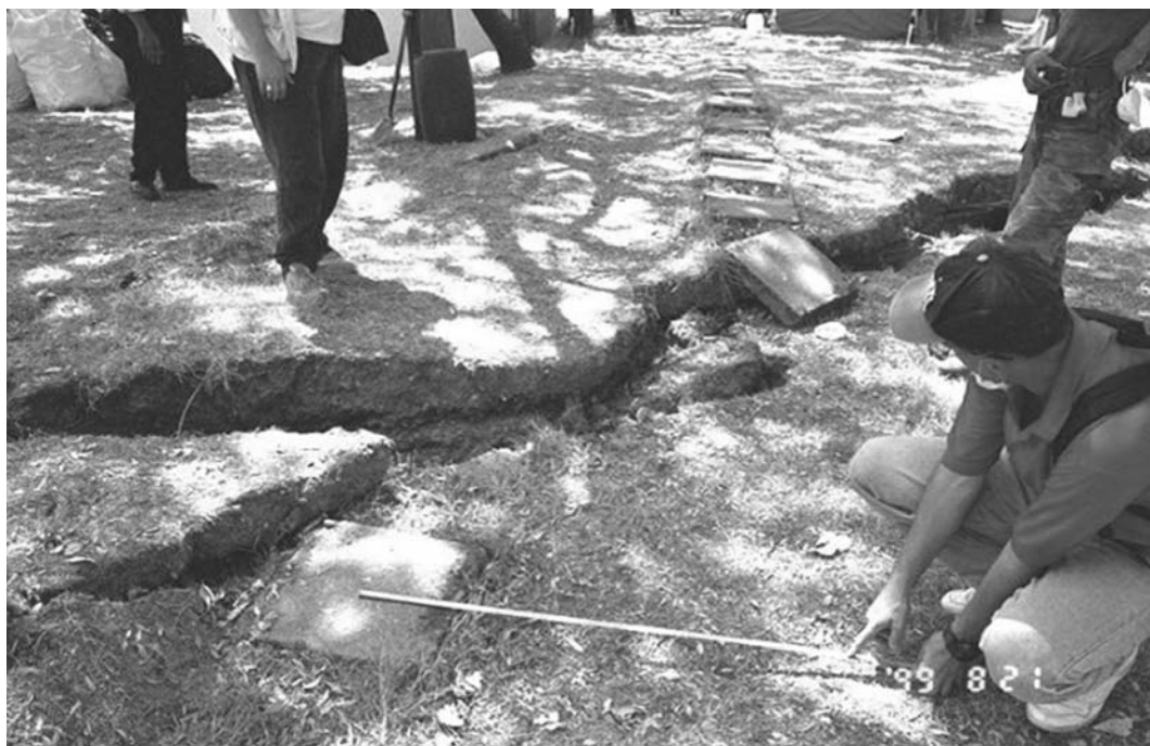
Fig. 14 – Medição de uma componente do deslizamento da falha. Sismo de Kocaeli (Turquia) de 1999.
