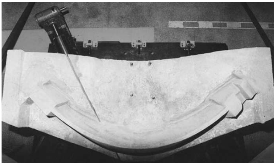
Fig. 33 – Barragem de Alqueva. Modelo físico antes do ensaio.
