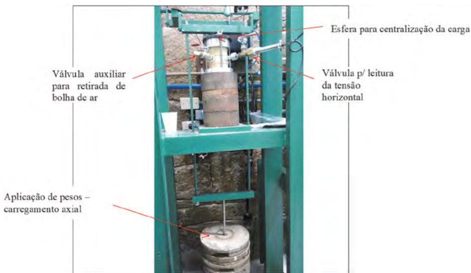
**Fig. 4** – Célula acondicionada na prensa. Início da aplicação do carregamento vertical
