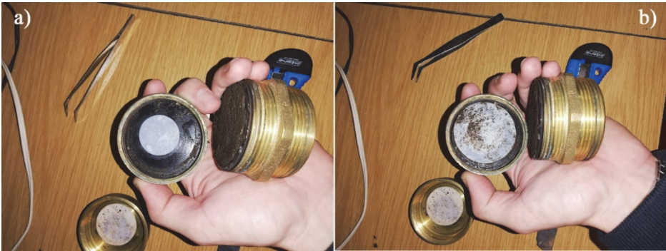
Fig. 1 – Aplicação de dois papéis de filtro concêntricos, com diâmetros de 30 mm (a) e 50 mm (b).
