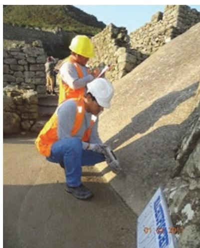
(a) Ensayo Esclerometrico
