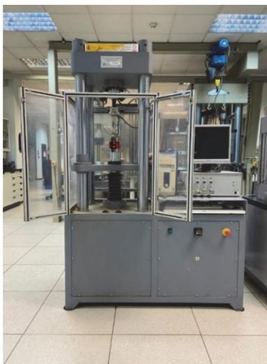
**Fig. 13** – Equipamento utilizado para o ensaio de tração directa em rocha no laboratório CEDEX.
