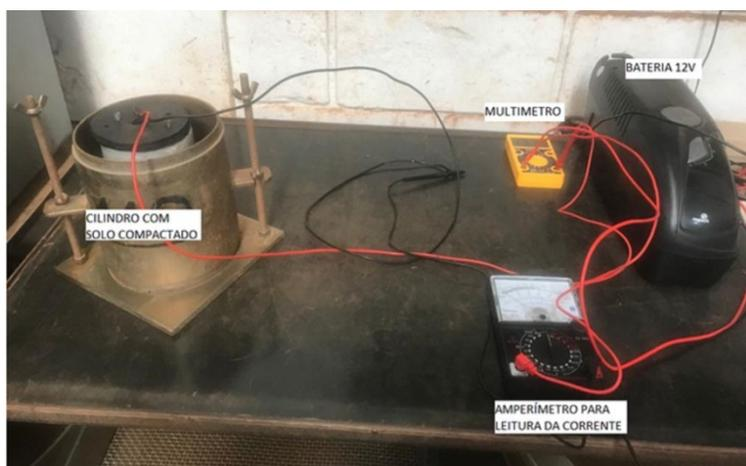
**Fig. 13** – Montagem do circuito para leitura da corrente elétrica no corpo de prova.
