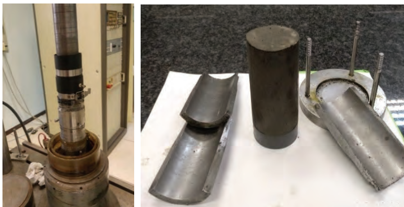
Fig. 28 – (Izquierda) Consolidación de la mezcla material más agua en una prensa independiente. (Derecha) Probeta resultante lista para montar en el equipo de columna resonante.
