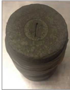
Fig. 30 – Probeta ensayada con elementos Bender. La hendidura central que se observa corresponde con el hincado del elemento Bender.
