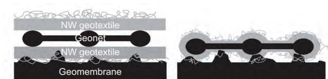
Fig. 14 – Mecanismos de interacción para bajos y altos valores de la tensión normal (Martínez Bacas et al., 2015a).
