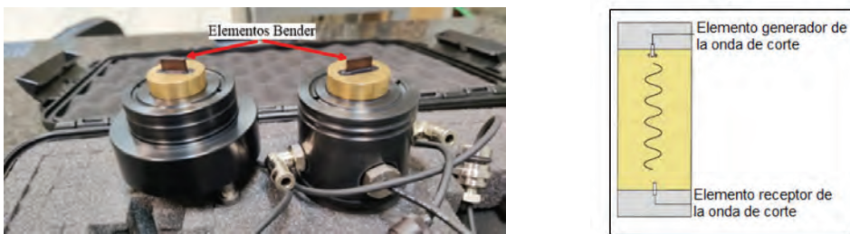
Fig. 13 – (Izquierda) Fotografía de los dispositivos que se instalan en cada uno de los extremos de la probeta y donde vienen insertados los elementos Bender. (Derecha) Esquema de funcionamiento del ensayo.
