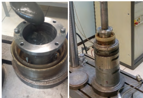
Fig. 18 – (Izquierda) Vertido de la mezcla de material y agua en el molde edométrico recrecido. (Derecha) Consolidación estática en una prensa independiente al equipo de corte.
