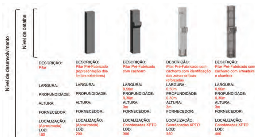
Fig. 9 – Exemplo de diferentes níveis de desenvolvimento e detalhe no modelo BIM (adaptado de Mcphee (2013) e de BIM Forum (2024)).
