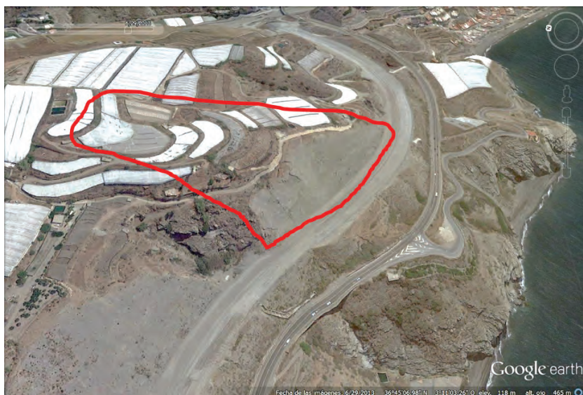
Fig. 8 – Vista de la zona afectada por el deslizamiento enmarcada dentro de la línea roja.
