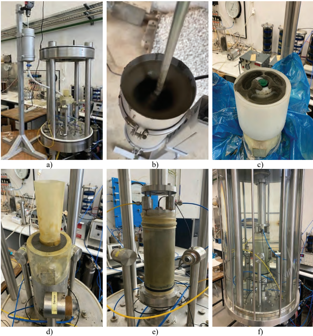
Fig. 6 – Sequência de montagem de amostras de rejeitados da mineração no HCA.: a) agitador mecânico; b) mistura dos rejeitados na cuba metálica; c) alongo após a deposição da pasta; d) amostra após assentamento; e) amostra com sucção; f) amostra com a instrumentação local instalada dentro da campânula.
