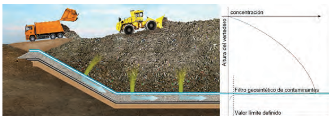
Fig. 3 – Esquema de funcionamiento de un filtro geosintético de contaminantes, HUESKER Synthetic GmbH.
