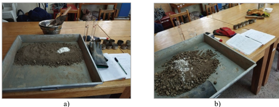
Fig. 2 – a) Dosificación del GG proporcional al peso de la muestra a ser ensayada; b) Proceso incorporación del GG y posterior mezclado con la muestra de suelo, mediante el batido manual en seco.
