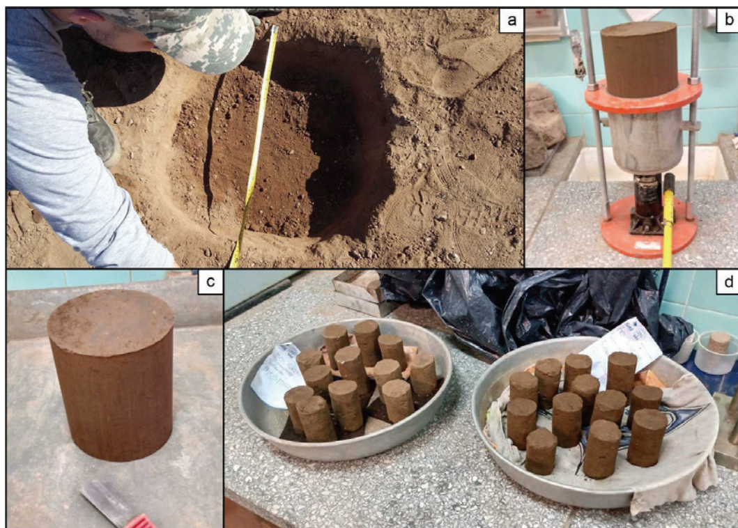
Fig. 11 – a) Cateo para caracterización del suelo natural en traza estudiada; b) Desmolde de probeta remoldeada con la dosificación óptima; c) Probeta pronta a ser tallada en probetas remoldeadas para ensayar durabilidad; d) Probetas esbeltas remoldeadas del ensayo de durabilidad.
