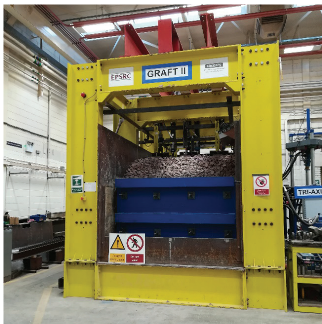
Fig. 6 – Equipamento GRAFT-2 (a ensaiar uma via balastrada).
