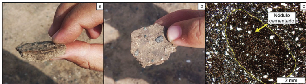
Fig. 3 – a y b) Lente de suelo estabilizado extraído de tramo piloto; c) Fotomicrografía tomada bajo microscopio petrográfico de una muestra estabilizada en campo (sección delgada), donde se puede ver un nódulo de bordes redondeados cementado por el silicato de sodio (nicoles paralelos).
