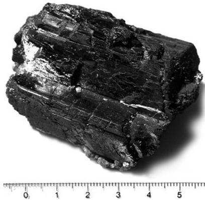
O volfrâmio é utilizado no endurecimento do aço tendo servido para fabricação de carris de caminho-de-ferro, de ferramentas de corte rápido de metais, e de lâmpadas elétricas com filamentos de volfrâmio.
