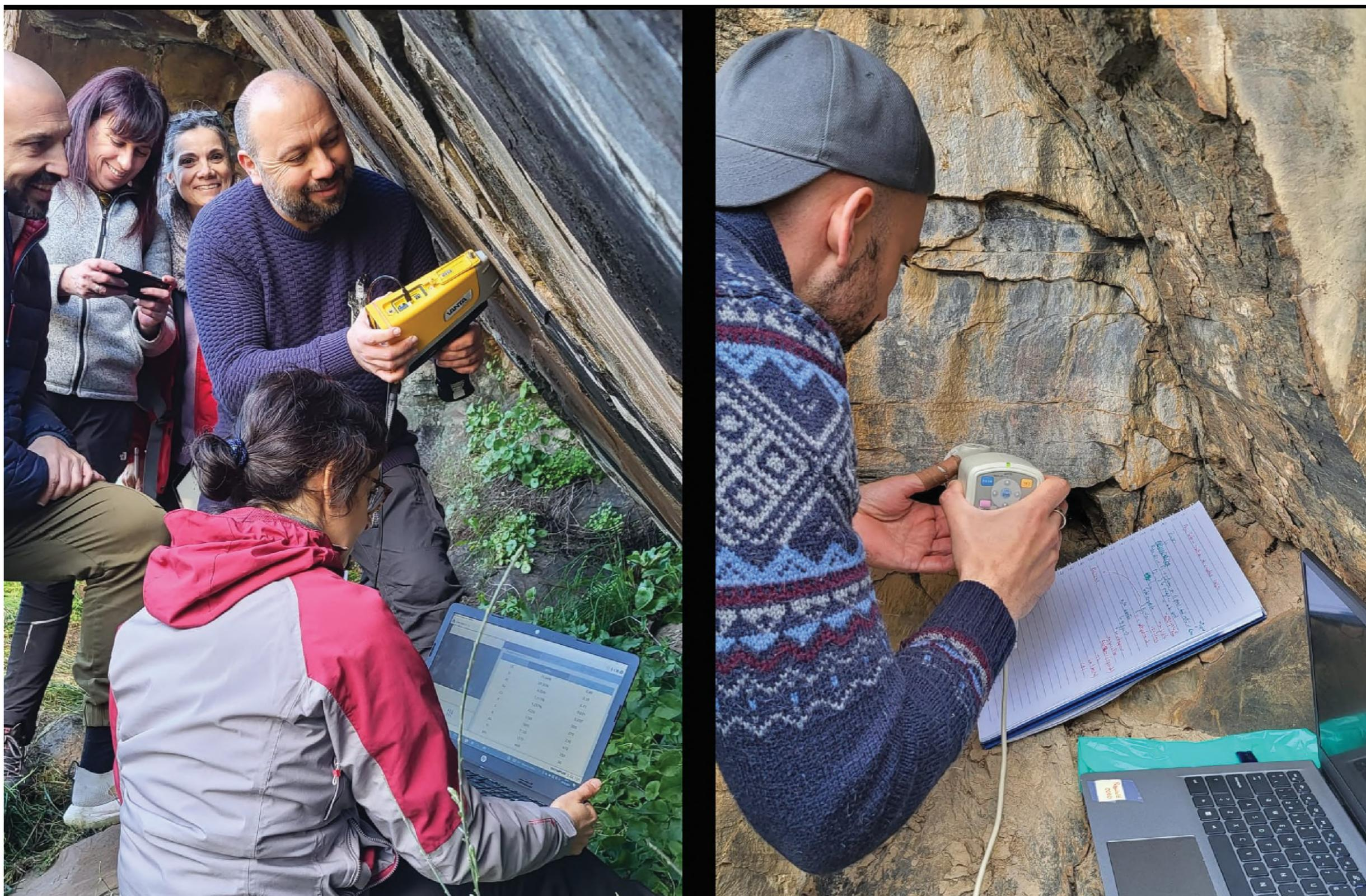
Fig. 6 – Exames realizados em *in situ* pela Universidade de Vigo em colaboração com o Incipit-CSIC - Consejo Superior de Investigaciones Científicas. À esquerda: espectrometria de fluorescência de raios X (FRX) no painel 2 do abrigo do Poço Torto, realizado por Lucía Pereira e Lois Armada, com Santiago Pozo-Antonio, Lara Bacelar Alves e Teresa Rivas Brea; à direita: espectrofotometria da cor no painel 3 da rocha 60 de Ribeira de Piscos, realizado por Santiago Pozo-Antonio.
