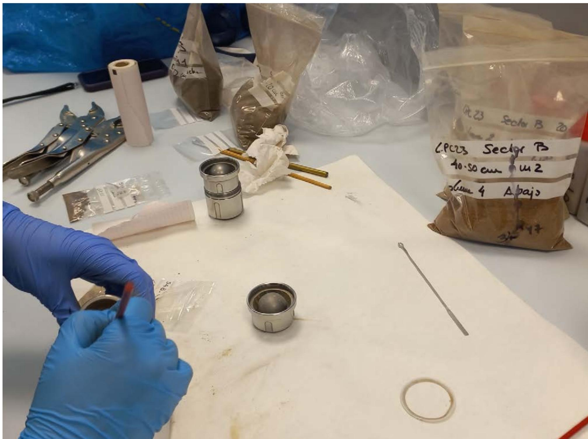
Fig. 5 - As amostras são secas à chegada ao laboratório. A preparação e análise das amostras é realizada em diversas fases, começando pelo laboratório de processamento onde são secas, moídas e medidas as primeiras propriedades, como acidez e cor. Na imagem, vemos o processo de moagem.
