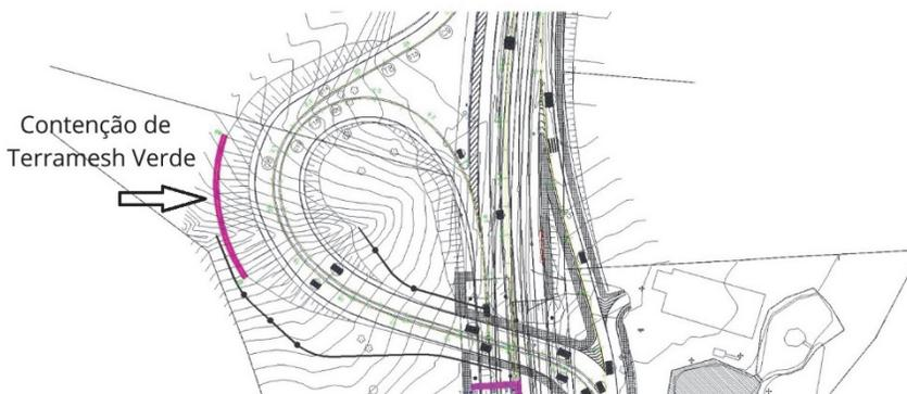
**Fig. 2** – Planta de localização da contenção na alça de acesso da interseção (adaptado de Departamento de Estradas de Rodagem do Estado do Paraná, 2018)
