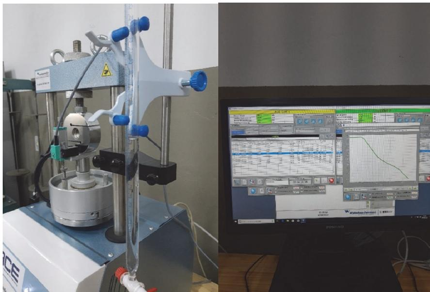
**Fig. 5** – Ensaio de adensamento sendo realizado no equipamento ACE automatizado.
