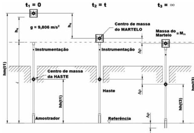
Fig. 1 – Definições para o cálculo das energias potenciais gravitacionais do martelo e da haste (Odebrecht, 2003).
