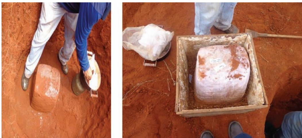
Fig. 2 – Coleta de amostras indeformadas.
