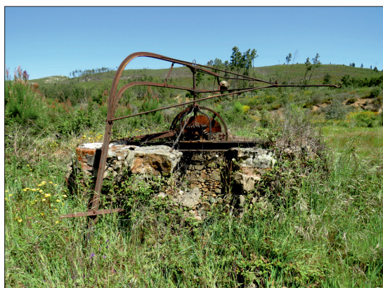
Fot. 1 - Nora de Alcatruzes de eixo curto - Aldeia de Sanguinheira - Mação (Fotografia de Susana Serrão, tirada em 2023).
