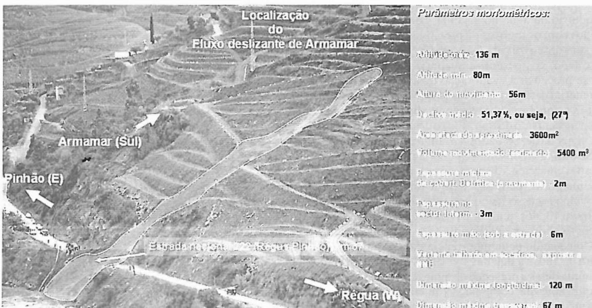
Figura 12 - O Fluxo deslizante, de Armamar; tabela-síntese de parâmetros morfométricos.
