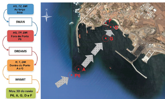
Figura 12 - Esquema de modelação para cálculo dos movimentos do navio e localização dos pontos onde foi aplicado o modelo WAMIT (imagem Google Earth™).
