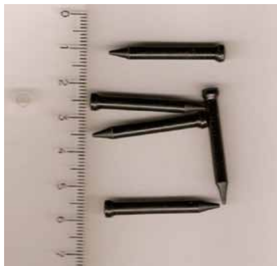
Fig. 3 - imagem da tag (conjunto chip e antena) em forma de prego, construído em resina biorresistente. Fonte: Antonio C. Sarti, 2009.
