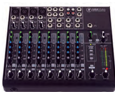
Fig. 4 - Mesa misturadora Mackie 1202 VLZ (Fonte: Manuais de serviço Mackie 1202 VLZ).
