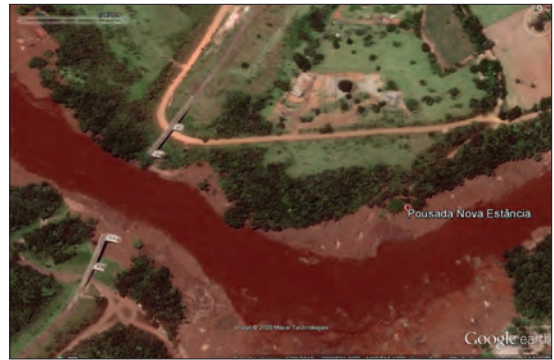
Fig. 4 - Imagens antes e depois do desastre na região compreendida entre o pontilhão (ponte para transito de trens de carga) e a pousada Nova Estância, em Brumadinho. Notar que a lama de rejeito de mineração seguiu o percurso do ribeirão Ferro Carvão, afluente do rio Paraopeba (Fonte da imagens: Google Earth).
