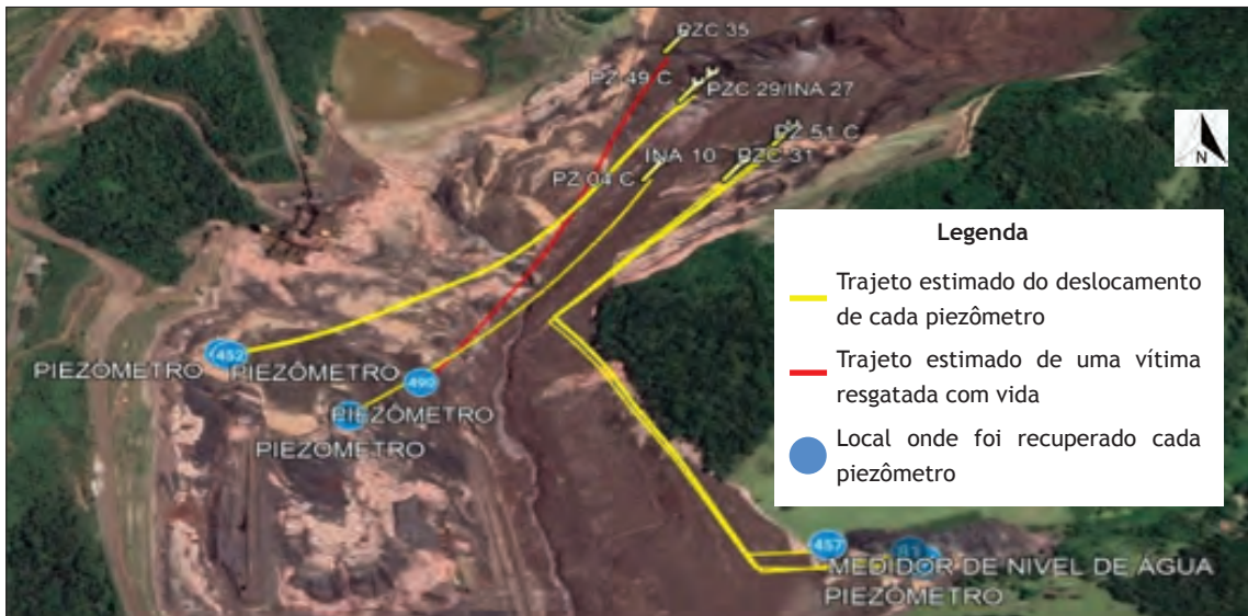
Fig. 9 - Croqui de deslocamento estimado dos piezômetros recuperados (Fonte: CBMMG, Banco de dados da Operação Brumadinho, adaptado de Google Earth).
