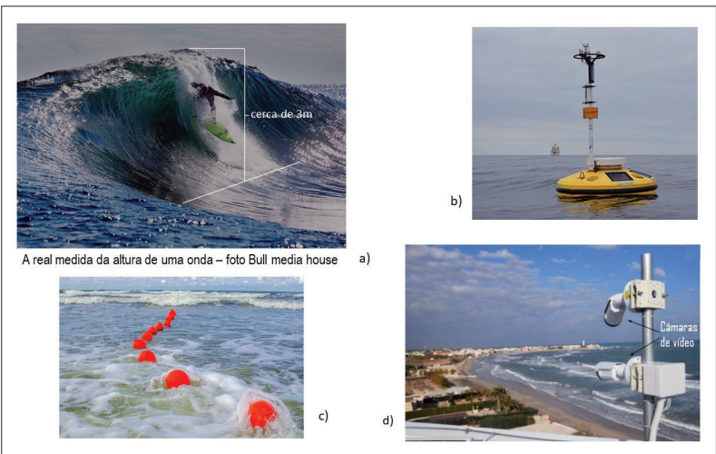
Fig. 4 - Métodos de estudo hidrodinâmico das ondas: a) medição da onda a olho nú; b) transdutores de pressão montados em trenós bentónicos; c) bóias; d) câmaras de vídeo (Fonte: Imagens Google, 2022; Andriolo, 2018).
