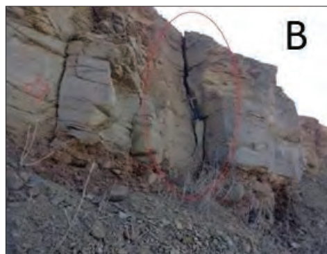
Fot. 5 - Presença de rochas bastantes alteradas (A) e fraturas nos estratos rochosos (B) na área de estudo (Fonte: Autores, 2015).
