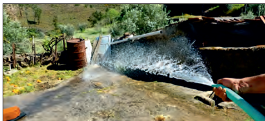
Fot. 14 - Demonstração de aumento manual de pressão, mangueira de 30 m e com diâmetro 32 mm (Fotografia de Susana Serrão, tirada em 2023).
