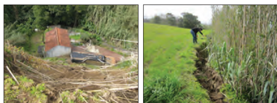
Fot. 13 - Exemplo de um caso de instabilidade num talude promovido pela alteração do tipo de uso do terreno que provoca a impermeabilização e consequente escorrência superficial.
